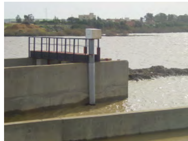
station de mesure de niveau et de salinité à l'écluse
